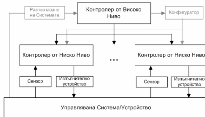
Фигура 2.3: Многослойна мрежова система за управление.
